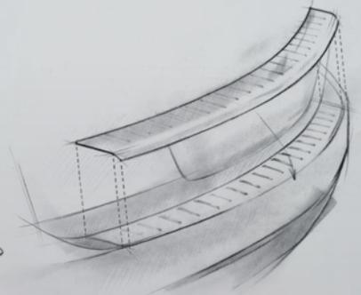
GROOVES ON THE BUMPER GUARD FIT INTO GROOVES ON THE BUMPER.
