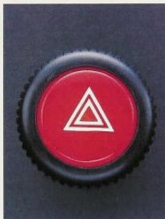
**Control de luces de emergencia.**- Valioso dispositivo de seguridad.
