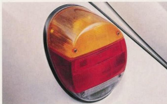
**Luces traseras.**- Integradas en una sola unidad, luces direccionales, de posición, freno y reversa.
