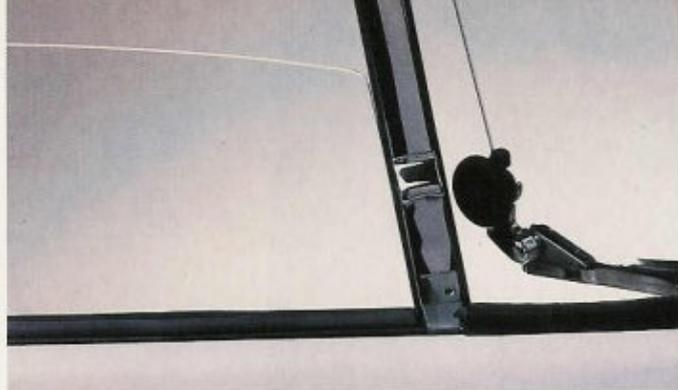
**Alas giratorias en ventanillas delanteras.**- Permiten la circulación del aire dentro del habitáculo.
