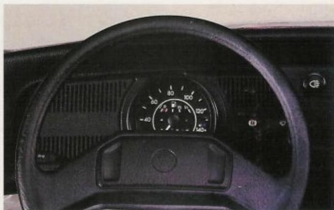
**Volante de lujo.** - Nuevo volante de exclusivo diseño de dos puntos de apoyo.
