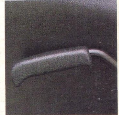
Asiento regulable del conductor. - Sistema mecánico para ajustar el asiento a la altura conveniente.
