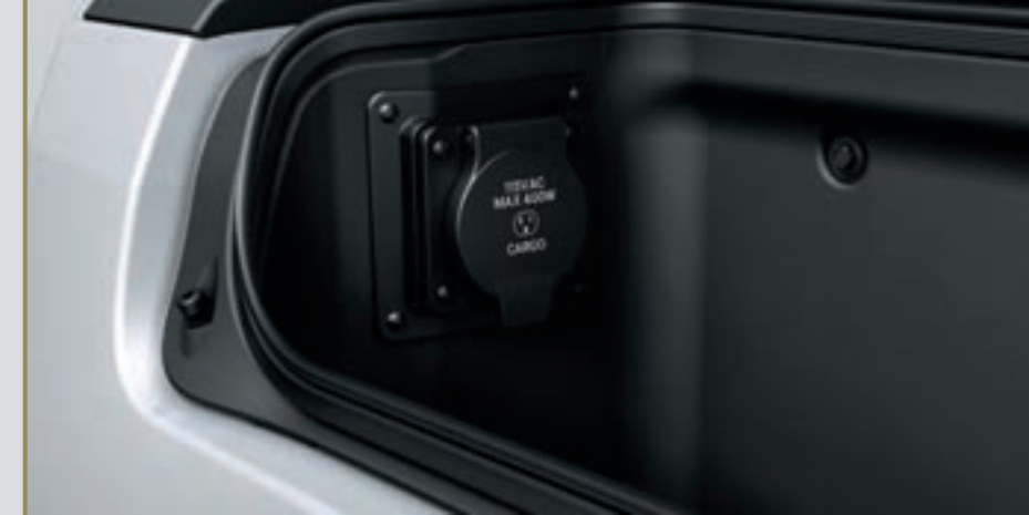
115-VOLT POWER OUTLET
