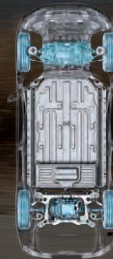
**MÁS POTENCIA** aplicada al pavimento. El Sistema de Tracción en Todas las Ruedas (All-Wheel-Drive, (eAWD) eléctrico, disponible, es capaz de utilizar toda la potencia, tanto del eje delantero como del eje trasero para brindar impresionante aceleración y maniobrabilidad.
