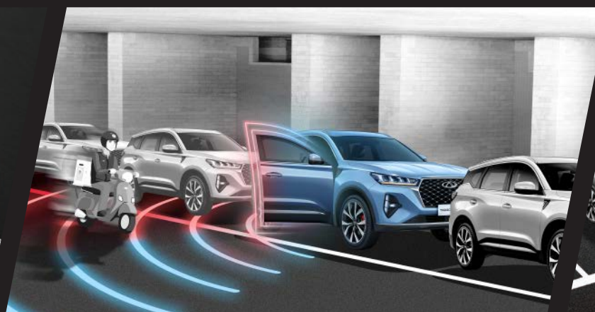
Door Open Warning (DOW)
