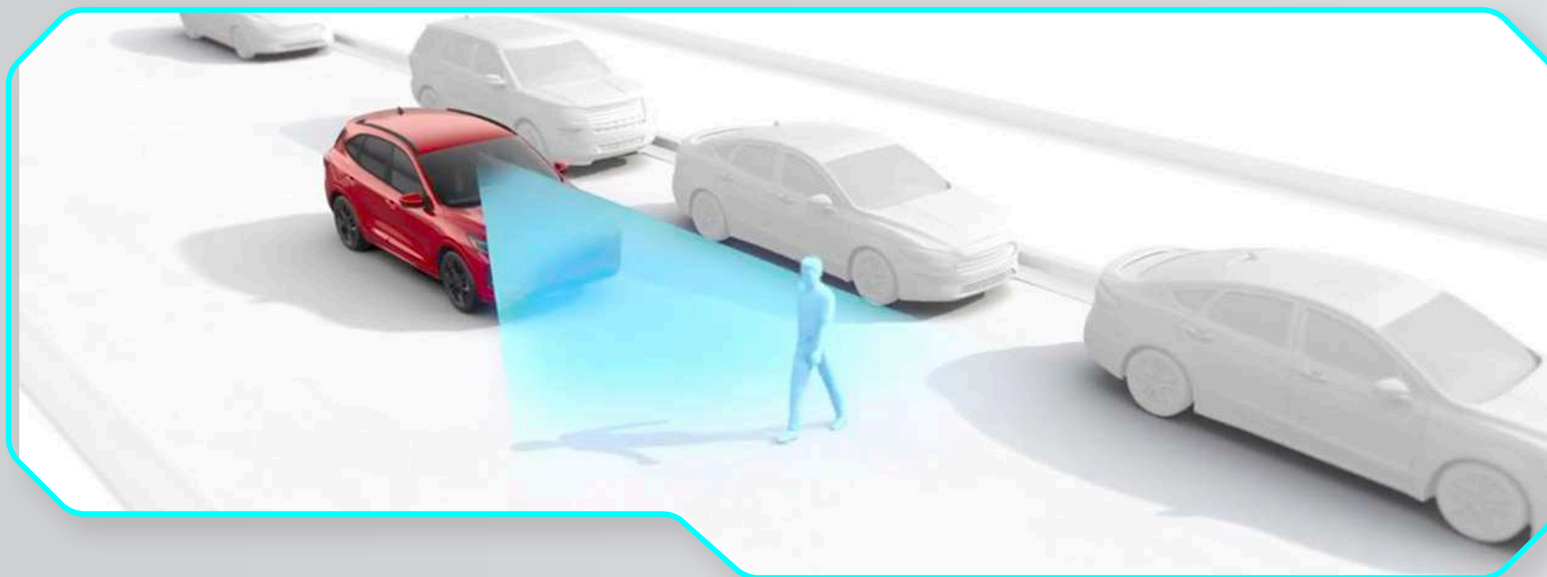
Asistencia de Pre-Colisión con freno de emergencia automático y detección de peatones
