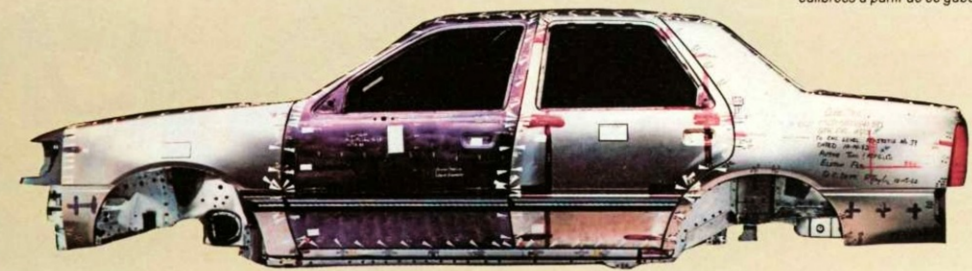
Les dimensions et l'ajustement des éléments de toutes les carrosseries de Topaz quatre portes sont calibrées à partir de ce gabarit.
