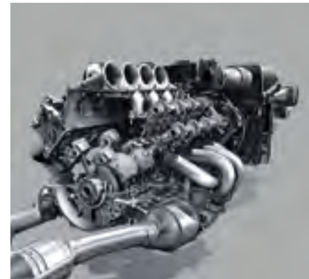
AMG 6.3-litre V8 front-mid engine
