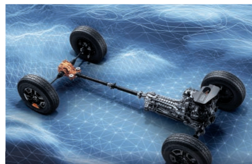
纯机械结构托森B型限滑后差速器 更强脱困能力
