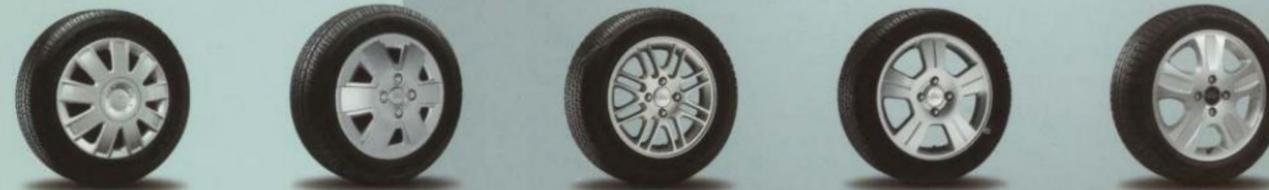
**RUEDAS ESTILIZADAS** De lqz. a Der.: De acero de 15" con cubiertas de 9 rayos • De acero de 15" con cubiertas de 6 rayos • De aluminio de 15" y rayos múltiples • De aluminio de 16" y 5 rayos • De aluminio maquinado de 16" y 5 rayos
