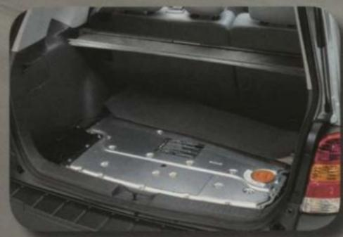
**DE LA PUISSANCE SOUS LE TAPIS** — Logée dans le plancher de l'aire de chargement, le bloc batterie au nickel-métal-hydrure (Ni-MH) de 330 volts de l'Escape hybride fournit l'énergie électrique nécessaire pour démarrer le moteur, conduire à basse vitesse et accroître la puissance d'accélération.
