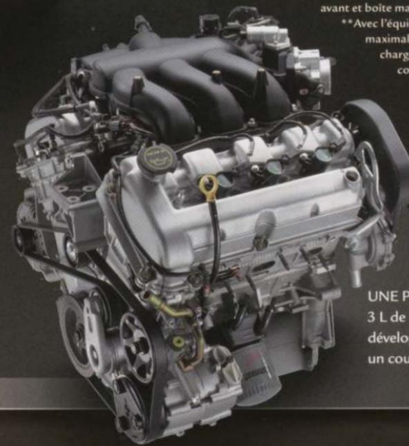
UNE PUISSANCE FORMIDABLE – Le moteur V6 Duratec 30 de 3 L de l'Escape, livrable, jumelé à la boîte automatique 4 vitesses, développe la puissance réjouissante de 200 chevaux et produit un couple de 193 lb-pi. De série pour les versions XLT et Limited.
