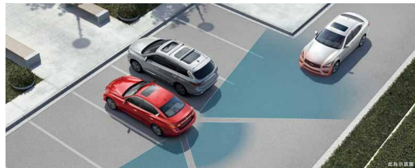
**BSI 盲點側撞預防系統附警示功能** 當您欲變換車道時，Q50 會以後保桿內兩側的遠距感應雷達偵測後方來車，並以燈號通知您盲點內有無來車，倘若距離過近，Q50 將自動協助修正。
