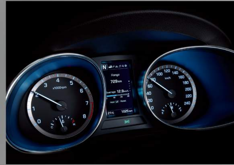
自發光儀表 / 4.2吋TFT全彩高解析度儀表顯示幕
