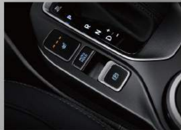
EPB電子式手煞車 / Auto Hold自動駐車系統
