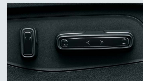
駕駛座10向電動座椅(前後滑動/椅背仰臥/椅墊前後高低/腰靠調整) + 副駕駛座4向電動座椅(前後滑動/椅背仰臥)
