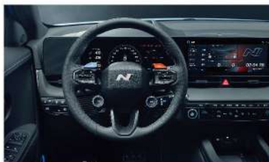
N 專屬性能多功能方向盤 N e-Shift 電子換檔回饋 (模擬八速 DCT 雙離合器變速箱)
