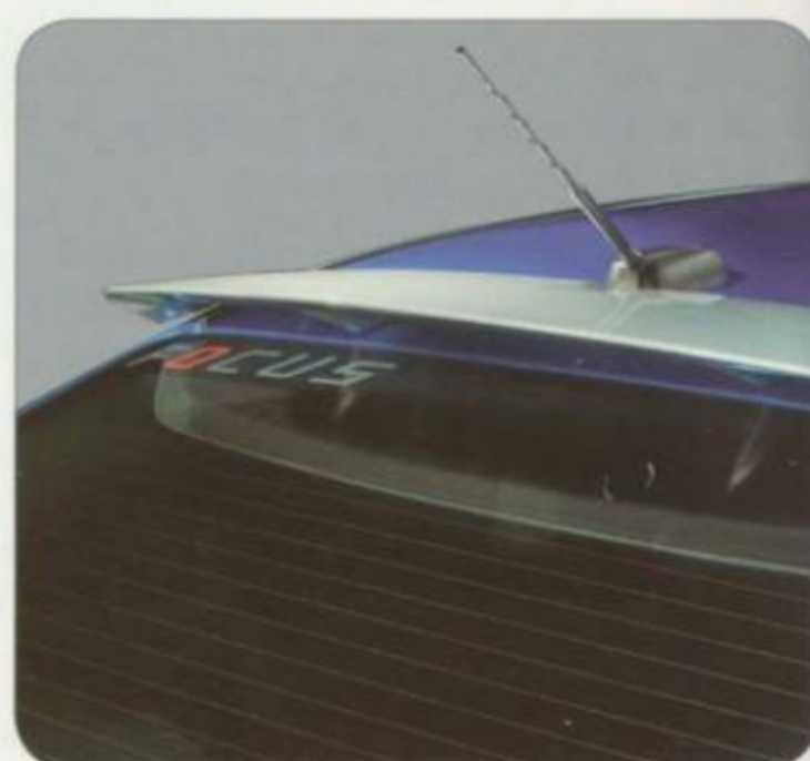
Becquet monté sur le toit
