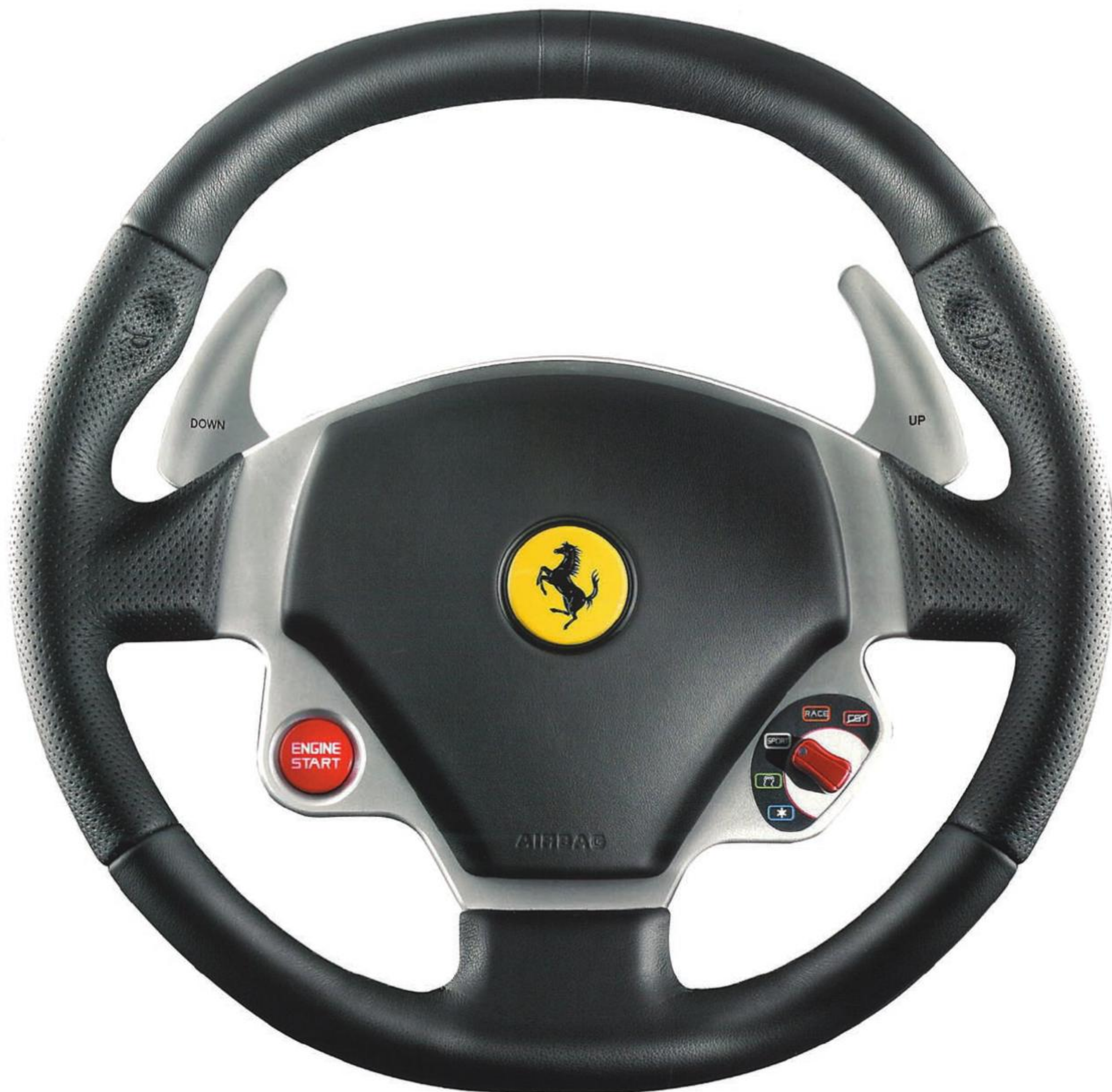
Il nuovo volante della F430 con cambio F1 The new steering wheel with integral engine start button and car set-up manettino
