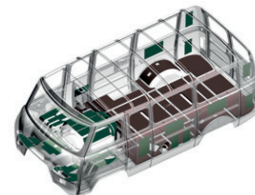
Улучшенный пакет вибро-шумоизоляции по всему кузову и специальные подушки крепления кузова
