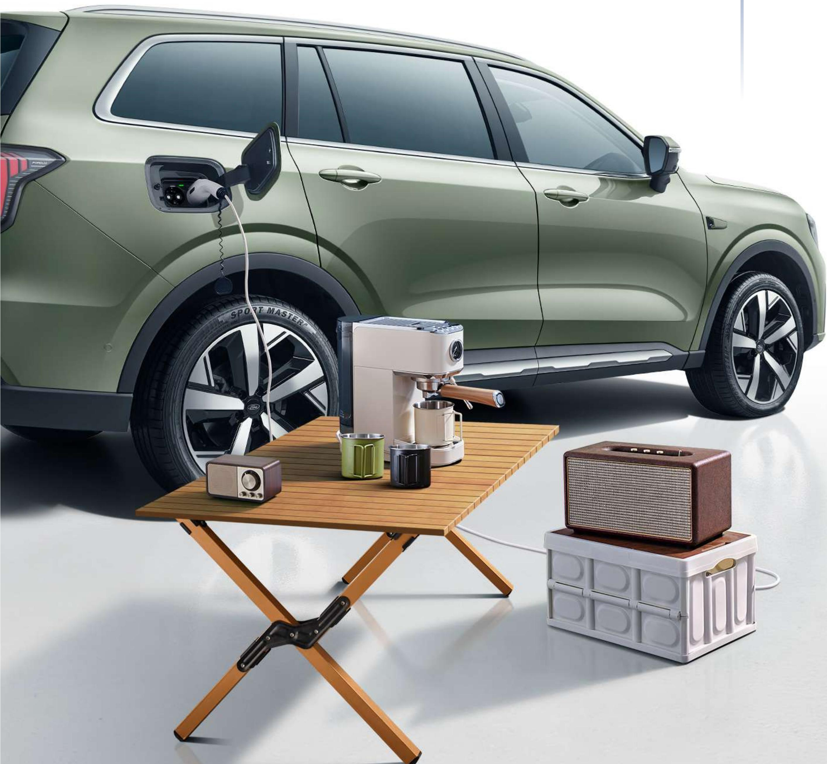
\* 领裕插电混动SUV对外放电功率为3.3kW，电压为220V。
